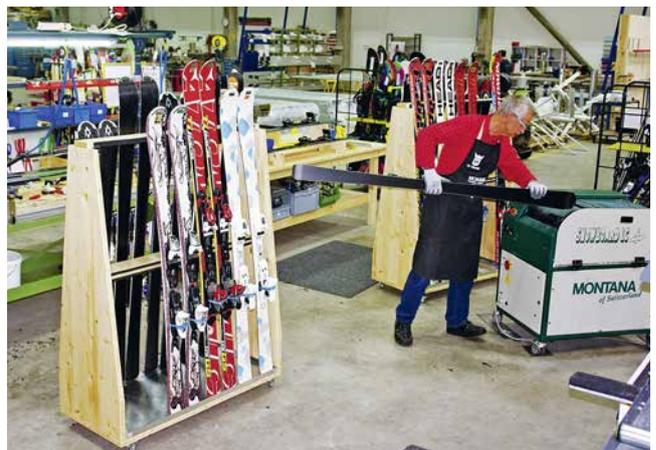
genauer entsprechend jeder Skigeometrie gesteuert. Damit wird die harmonische Bewegung des Skifahrens in den Steinschliff integriert. Die Skilänge wird automatisch vermessen, und das Ansaugsystem passt sich an. Die neueste Maschine beim Imholz Sport deckt jeden Schritt im Skiservice umfassend ab. Thomas Imholz: «Sehr wichtig ist daher die Beratung, damit unsere Kundinnen und Kunden von den besonderen und zahlreichen Möglichkeiten des Skiservices optimal profitieren können.» >>
